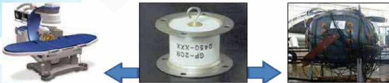
চিত্র : Nuclear Dual-Use Example: Triggered Spark-Gaps
